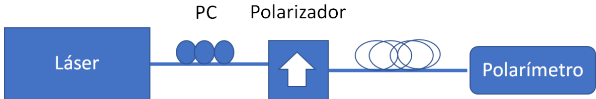
Fig. 2.1.11. Arreglo experimental para la determinación de la elipticidad de salida de los carretes torcidos de fibra óptica.
