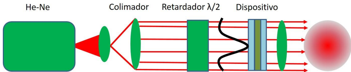
Figura 15. Arreglo experimental para visualizar las lentes generadas por interacción térmica.
