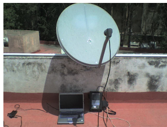
(a) Antena parabólica con diámetro de 0.76 m utilizada para la detección.
