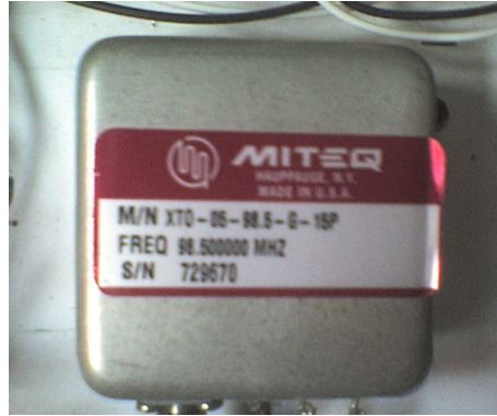
Figura 4.5: Oscilador local a 98.5 MHz con estabilidad de \pm 0.1 ppm situado en el bloque de control. Sincroniza los osciladores de 10835 MHz ubicados en el mezclador de cada LNB.
