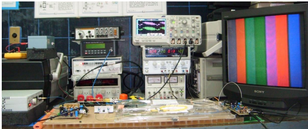
Figura 5-17. Esquema experimental para la transmisión de audio y video, utilizando sub-portadora PWM y modulación óptica de retardo.
