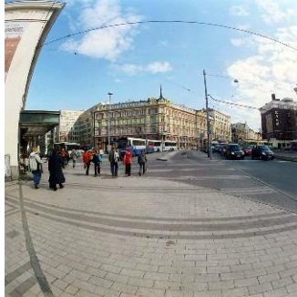
Figura 2.1 Imagen tomada mediante un lente fish-eye , mostrando la distorsión que genera el lente.
