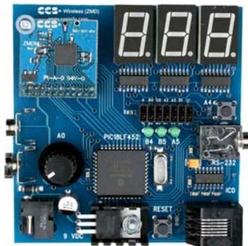
Figura 3.2 Tarjeta inalámbrica prototipo edición ZMD
