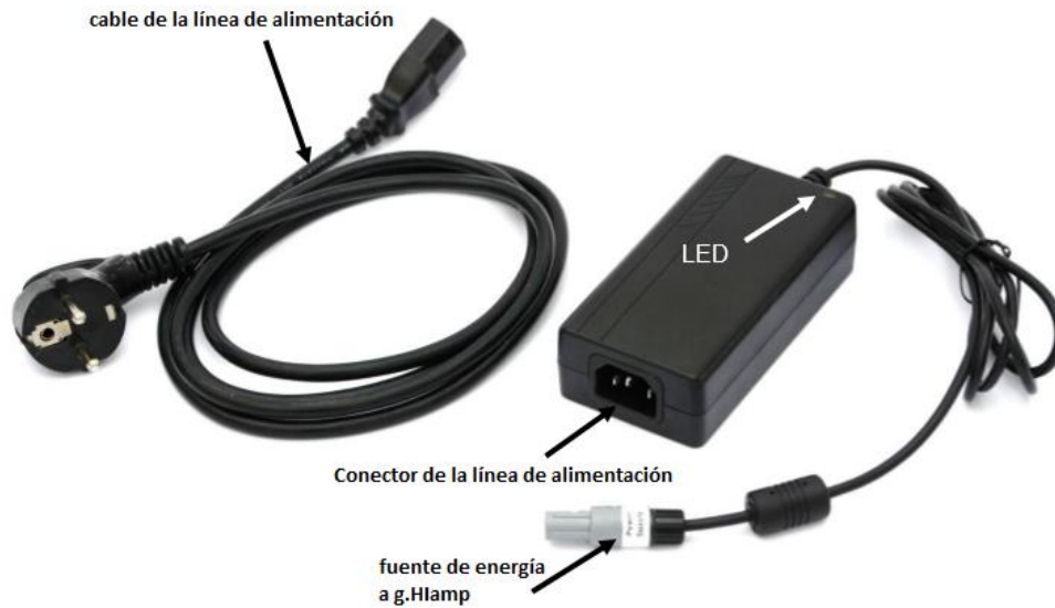
Figura 71. Cable de energización de para g.Hlamp
