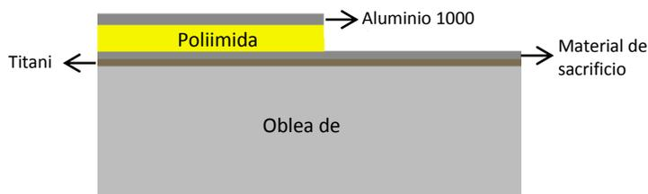
Figura 3.27 Películas de aluminio utilizadas como material enmascarante y de sacrificio para grabar y liberar patrones de poliimida.
