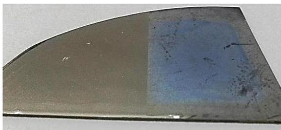
Figura 3.19 Patrón de grabado de la poliimida: del lado derecho se observa la película con residuos carbonizados que se forman durante el grabado anómalo.
