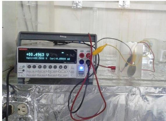
Figura 4.11 Montaje para el proceso de liberación anódica.
