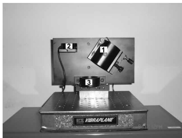
FIGURA 1. Instrumento para medir inclinaciones, 1 láser, 2 detector de cuadrante y 3 contenedor de aceite.
